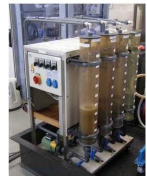
BFI Technikumsanlage zur Kühlwasserbehandlung
